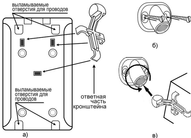
Рис.1 а) Вид на заднюю стенку извещателя; б) крепление кронштейна; в) Схема соединения кронштейна и держателя
