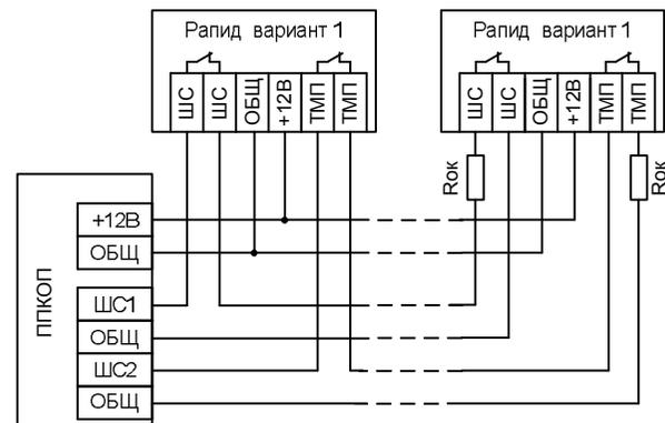
Рис.2 Схема подключения извещателей Рапид вариант 1 к ППКОП
