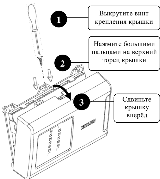
Рисунок 2.2.2. Снятие крышки прибора
