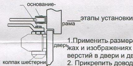
1. Применить размеры, указанные в чертежах и изображениях для высверливания отверстий в двери и дверной раме.
