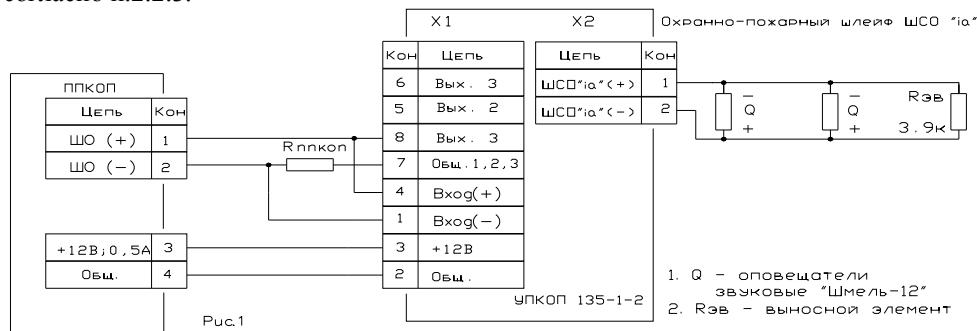
Совместно с оповещателями в искробезопасный шлейф сигнализации и управления "ia" устройства УПКОП 135-1-2 может быть подключены дополнительные элементы контроля, управления, оповещения, пуска и сигнализации ППКОП по схеме рис. 2. В данной схеме подключения может быть реализован только один из трех возможных сигналов ("Тревога1", Тревога2", "Тревога3") согласно п.2.2.3.
