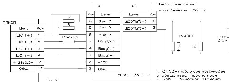
При необходимости получения трех звуковых сигналов согласно п.2.2.3. оповещатели следует подключать к двум шлейфам по схемам согласно рис.3, рис.4.
