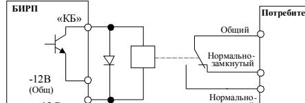
В качестве реле может быть использовано любое реле на 12В и током потребления не более 50 мА. В качестве защитного диода может быть использован диод марки 1N4001
