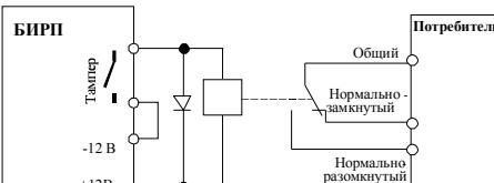
В качестве реле может быть использовано любое реле на 12В и током потребления не более 50 мА. В качестве защитного диода может быть использован диод марки 1N4001
