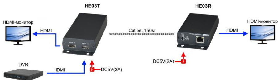
Рис.4 Типовая схема подключения комплекта удлинителя HE03 «точка-точка»
