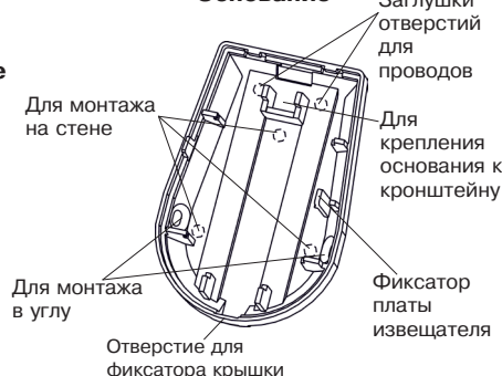
Рисунок 3 – Основание извещателя и кронштейн
